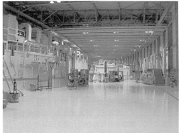
写真1 SPring-8のレーザー電子光ビームラインBL33LEP。写真左側のレーザーハッチから蓄積リングに向かってレーザーを入射し、散乱されて来た高エネルギーガンマ線を用いた実験を写真右側の実験ハッチで行っている。
