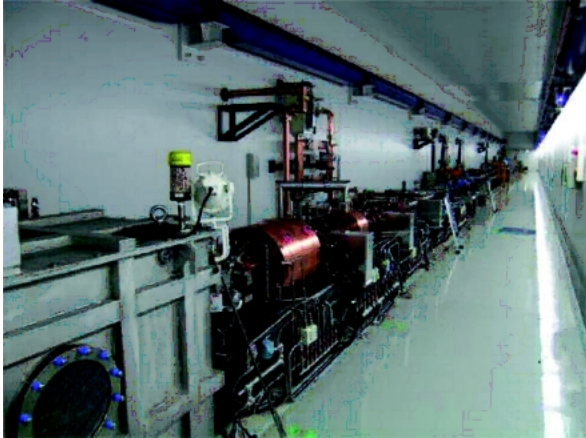
図14 XFELのプロトタイプ機2006年6月20日にレーザー発振に成功した
