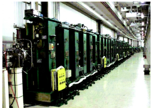
図12 世界最大の真空封止型アンジュレーター真空封止挿入光源は原型が KEK-PF で開発され、SPring-8 で本格的に使用されて世界に広まった
