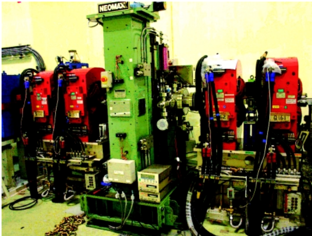
図10 KEK-PF の高度化計画の一例 (BL17)。偏光磁石光源部の磁石配列を大幅に変えてショートギャップアンジュレータ (SGU, 図の中央) の両側の磁石配列を変えて SGU を挿入する直線部を新設した。(KEK 山本樹氏提供)
