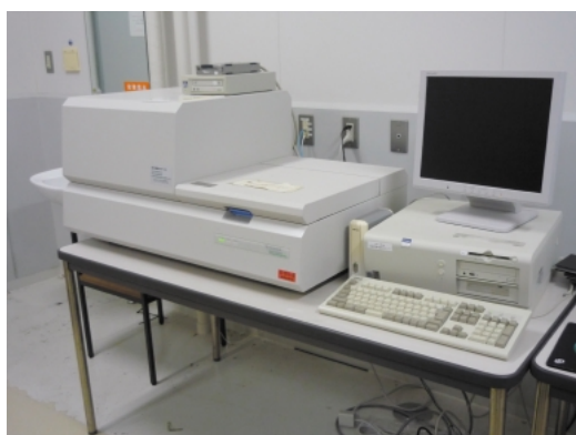
Fig. 5 SPring-8 に共同利用機器として設置されている IP 読出し装置 (富士フイルム社製 BAS2500)。
