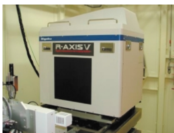
Fig. 12 大型高速 IP 検出器 (リガク R-AXIS V) の全容。
